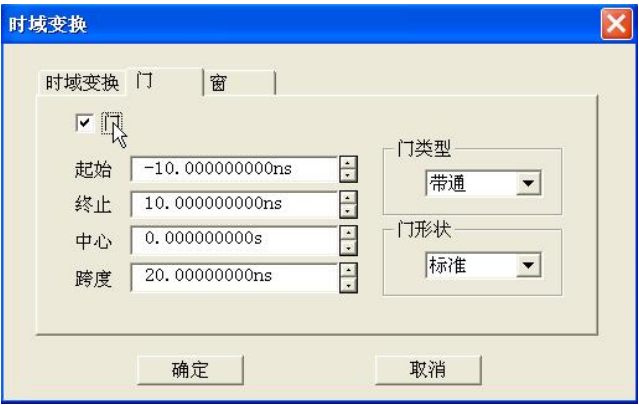
附图 2.26 时域变换测量-设置门
