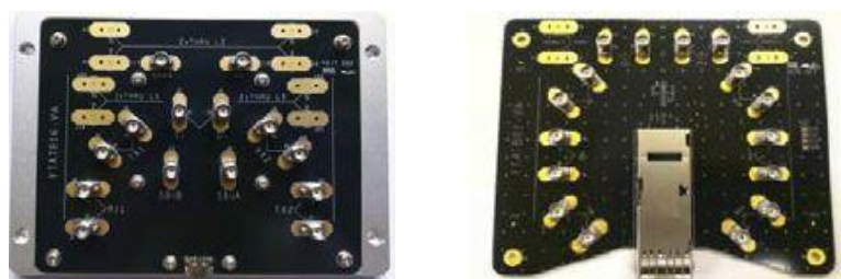
附图 4.3 连接器的测试夹具(左侧是 Type-C,右侧是 QSFP+)
