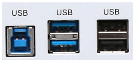
图 3.32 USB 连接器（左侧为 B 型配置，右侧为 A 型配置）
