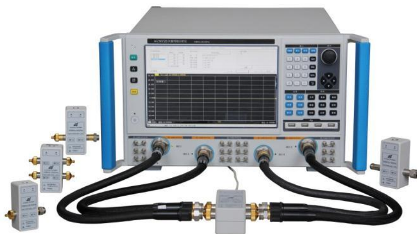
图 7.41 四端口网络仪与电子校准件连接
