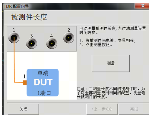
附图9.9 测量被测件长度
