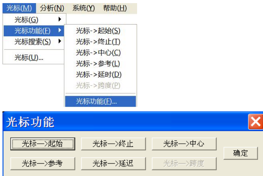
图 3.54 使用光标功能对话框设置测量
