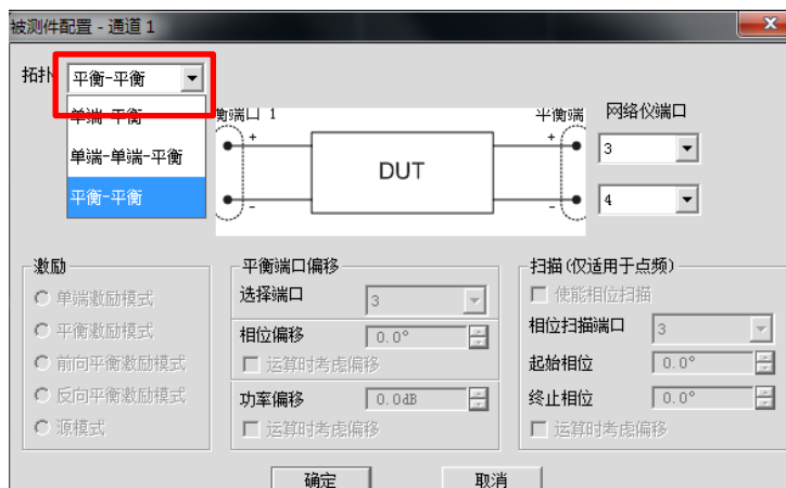
图 4.8 差分平衡 S 参数拓扑设置对话框
