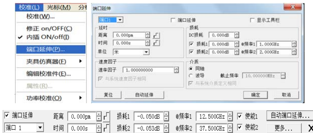
图 6.7 设置端口延伸
