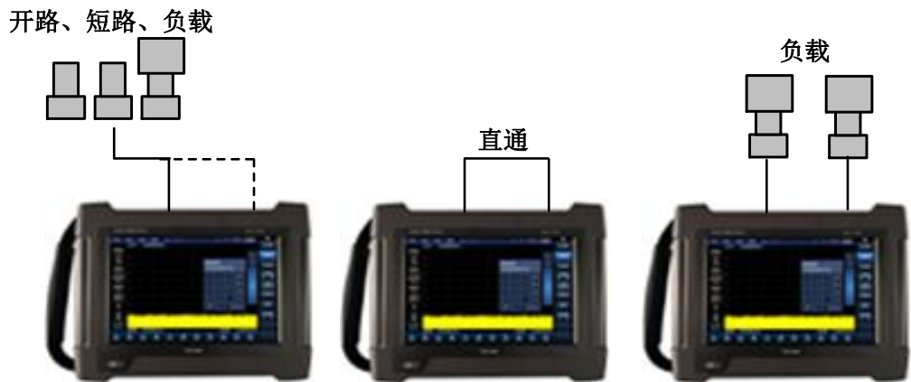
图 6.8 负载匹配测试框图
