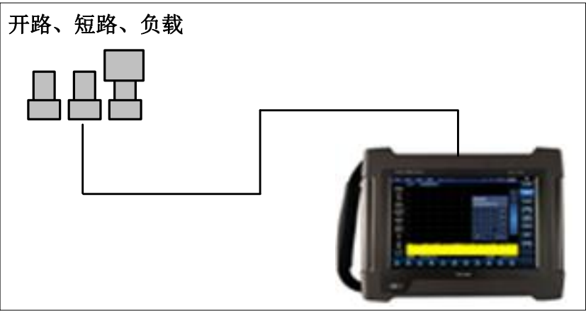
图 6.5 有效方向性、有效源匹配、反射跟踪测试框图
