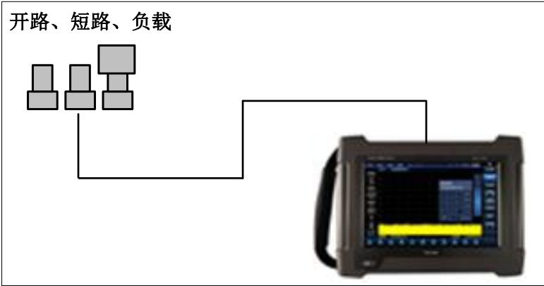
图 6.7 有效方向性、有效源匹配、反射跟踪测试框图
