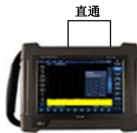
图 6.11 迹线噪声测试框图
