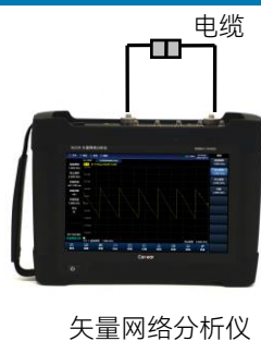
图 3.3 传输测量响应误差修正的标准件连接
