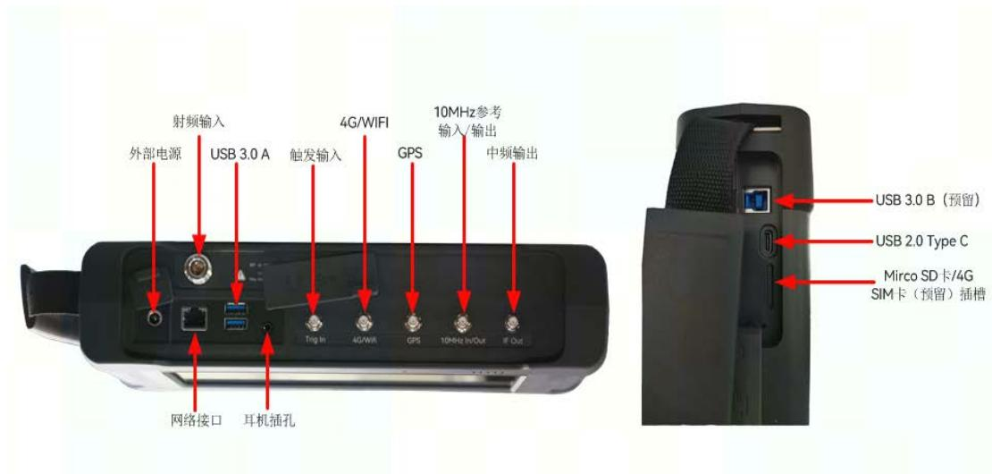
图 2.3 4025D 顶部 (左) 和侧面 (右) 面板
