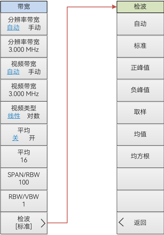
图 5.6 干扰分析模式带宽菜单结构框图
