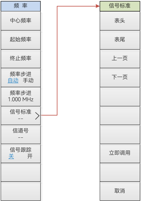
图 4.31 频谱分析模式频率菜单结构框图
