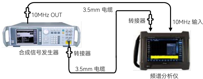
图 19.7 分辨率带宽转换不确定度测试设置
