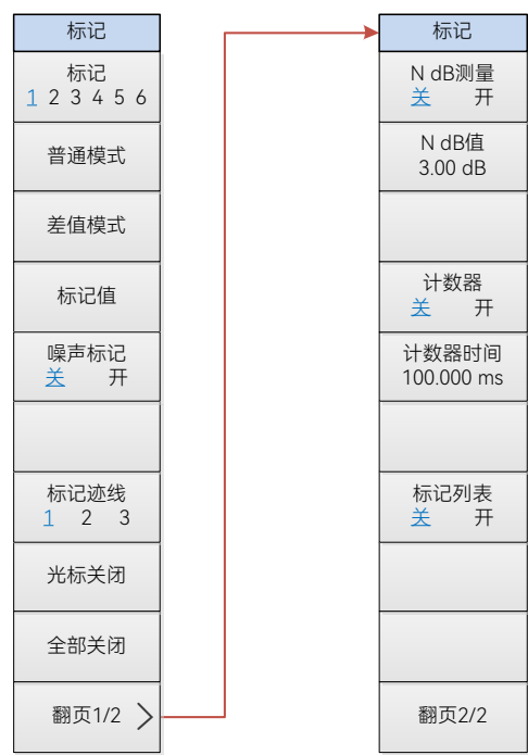
图 4.35 频谱分析模式标记菜单结构框图
