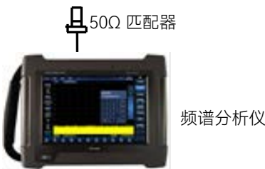
图 19.9 显示平均噪声电平测试设置
