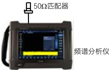
图 19.14 剩余响应测试设置
