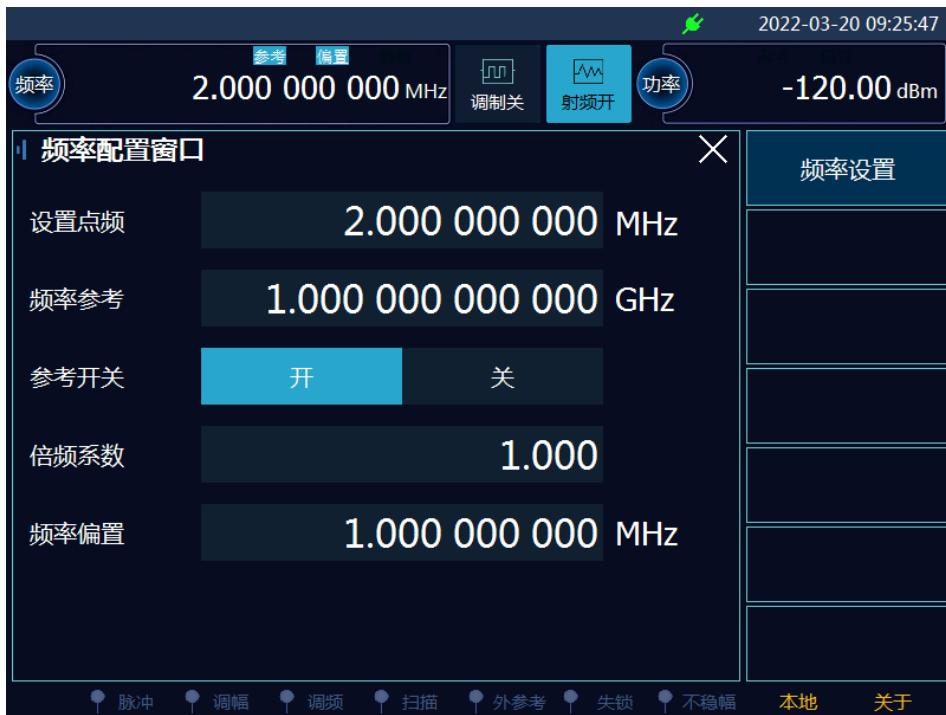
图 3.13 设置频率参考 1GHz 和频率偏置 1MHz
