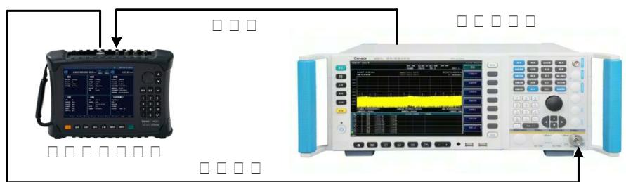
图 7.15 调频频偏准确度测试框图
