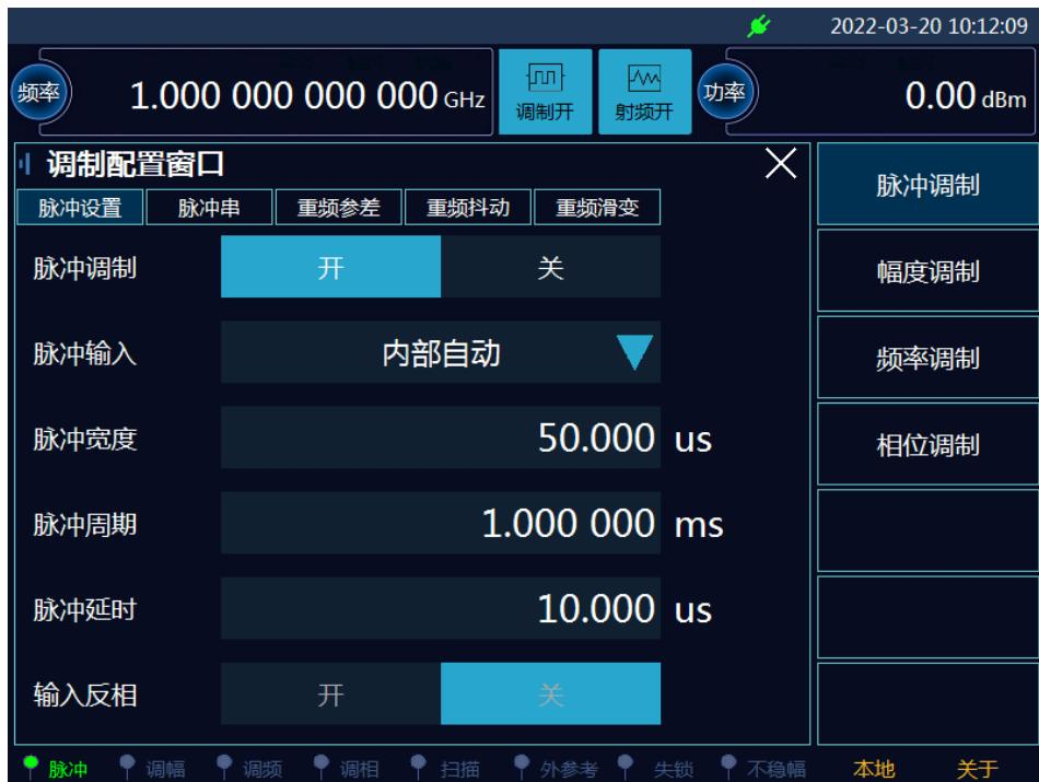
图 4.5 设置脉冲调制信号
