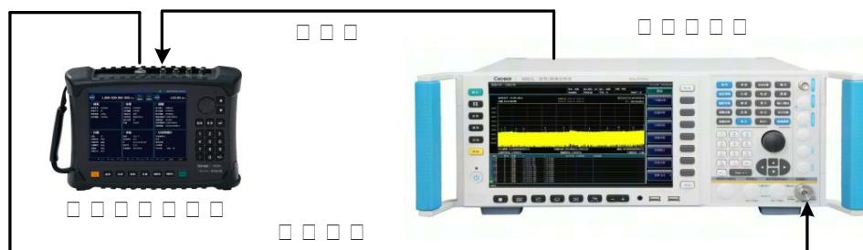
图 7.9 脉冲调制开关比测试框图
