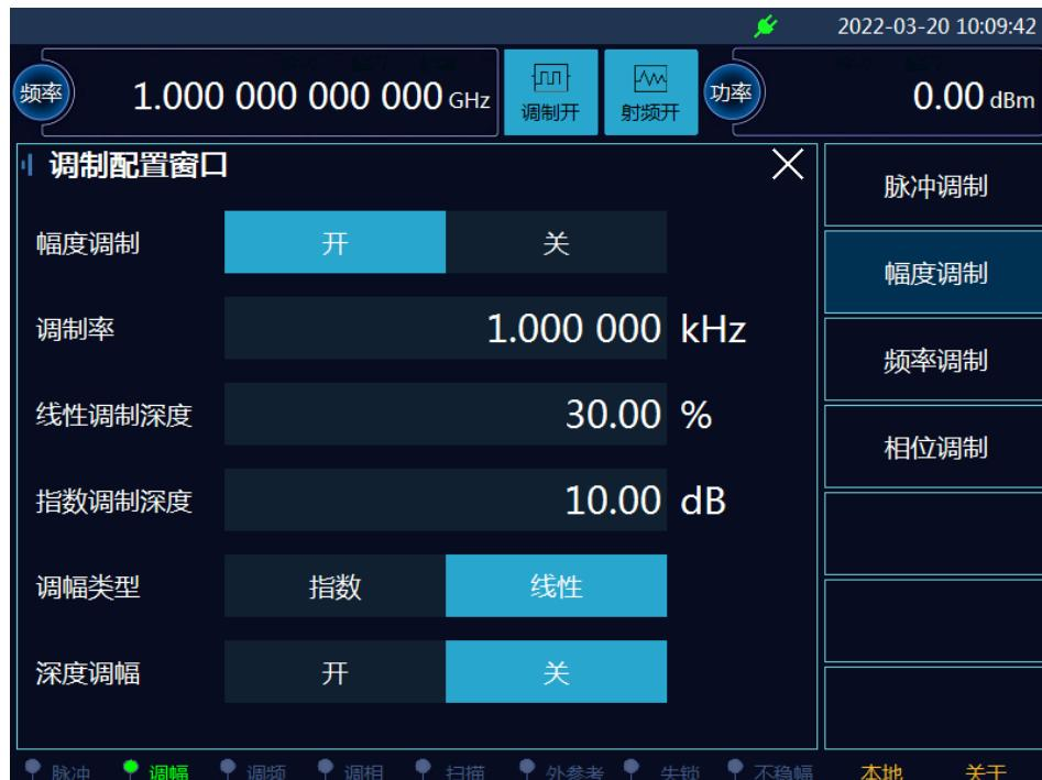
图 4.3 设置幅度调制信号
