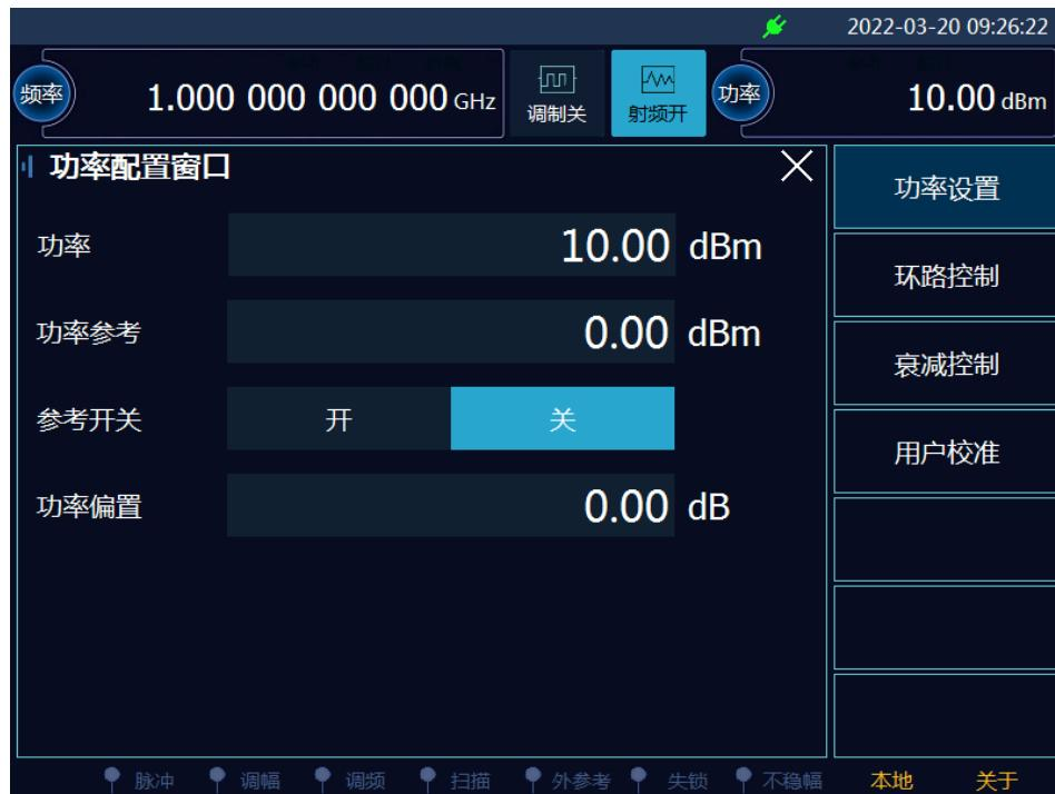
图 3.14 步进增加输出功率 10dBm
