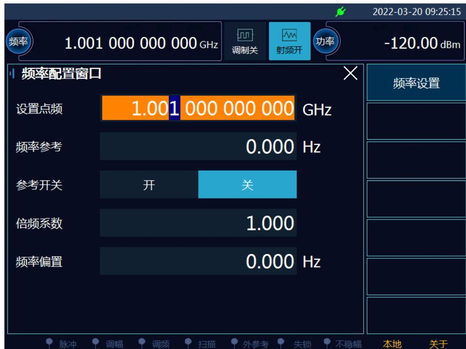
图 3.12 步进增加输出频率 1MHz
