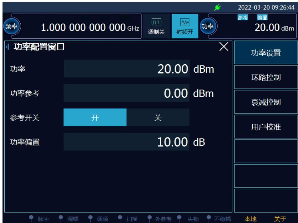
图 3.15 设置功率参考 0dBm 和功率偏置 10dB
