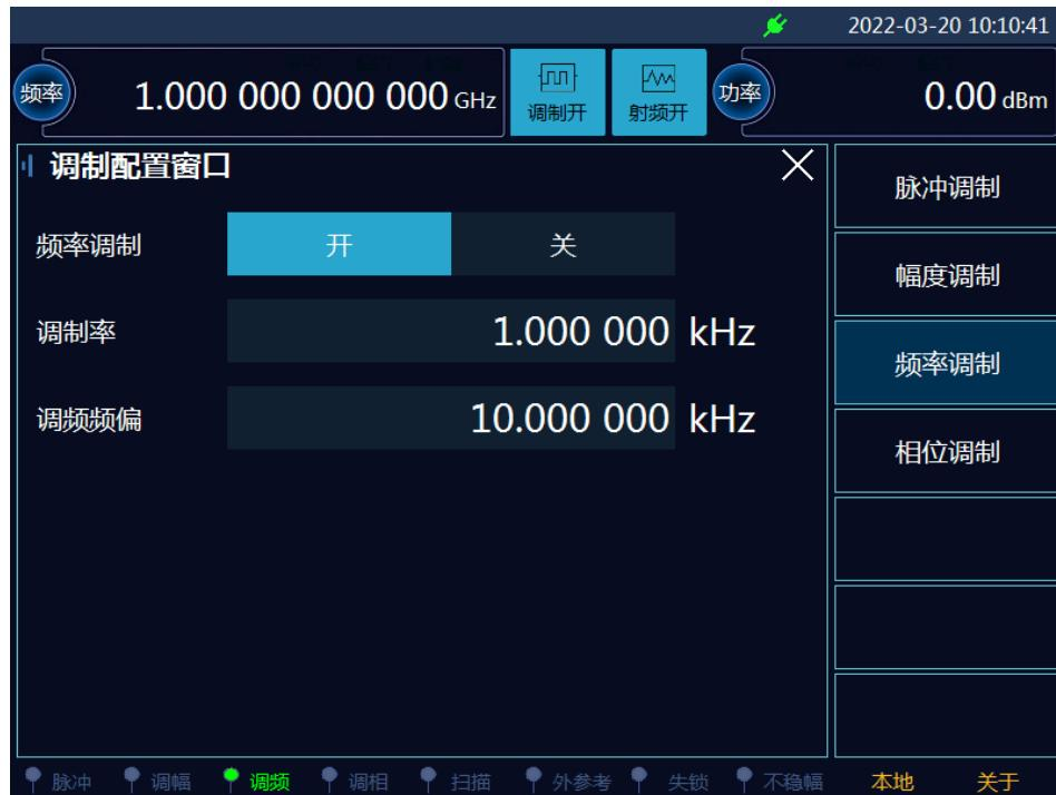
图 4.4 设置频率调制信号
