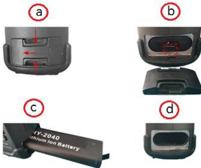
图 3.6 1433 系列信号发生器电池更换图解
