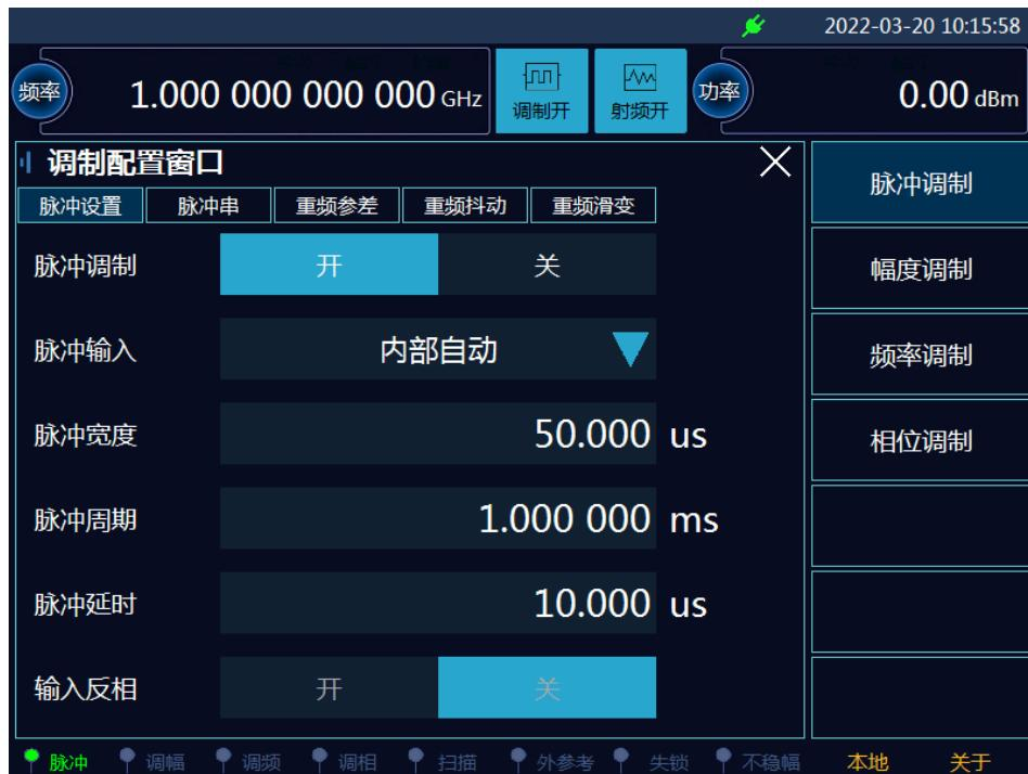
图 3.17 设置脉冲调制信号
