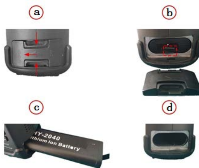
图 2.8 1433 系列信号发生器电池更换图解
