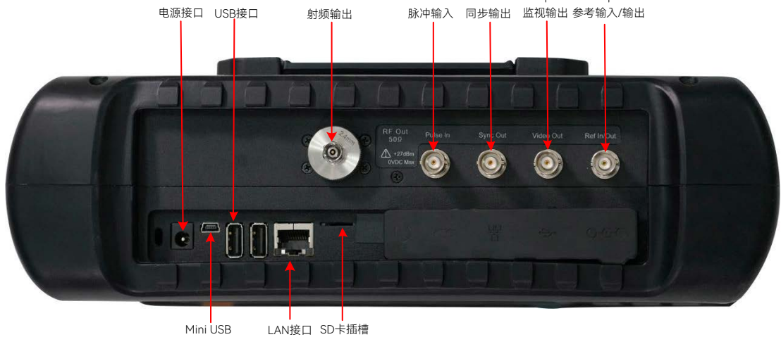
图 2.7 1433 系列信号发生器顶部接口
