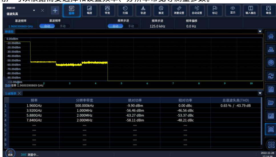
图 4.23 谐波失真测量结果
