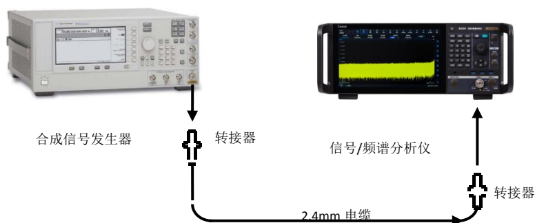
图7.17 相位噪声测试示意图
