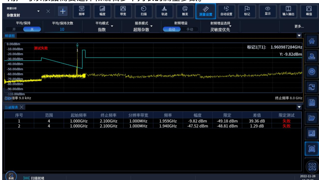
图 4.27 杂散发射测量结果
