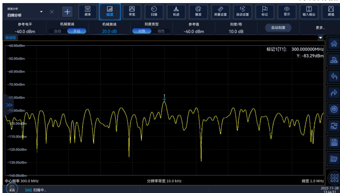
图 4.5 衰减器 20dB 时的小信号
