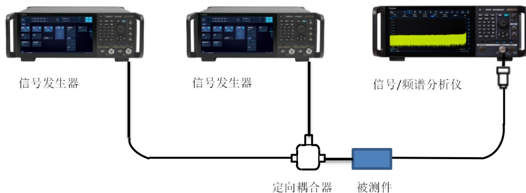
图 4.24 三阶交调测量连接设置
