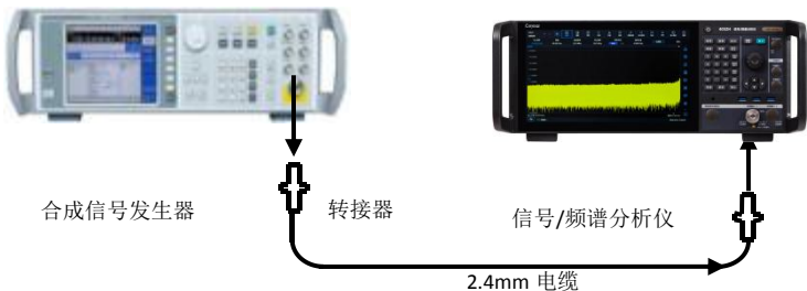
图 7.3 剩余调频测试示意图
