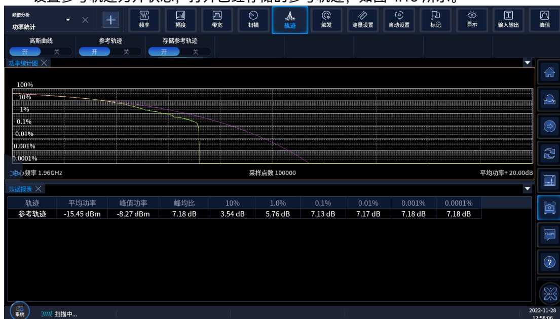
图 4.18 存储和显示 CCDF 测量
