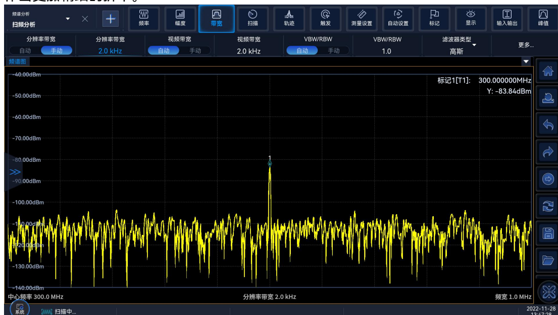
图 4.7 减小分辨率带宽测量小信号
