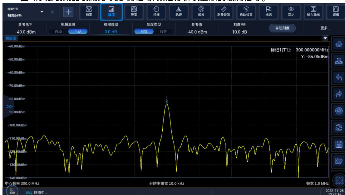
图 4.6 衰减器 0dB 时的小信号
