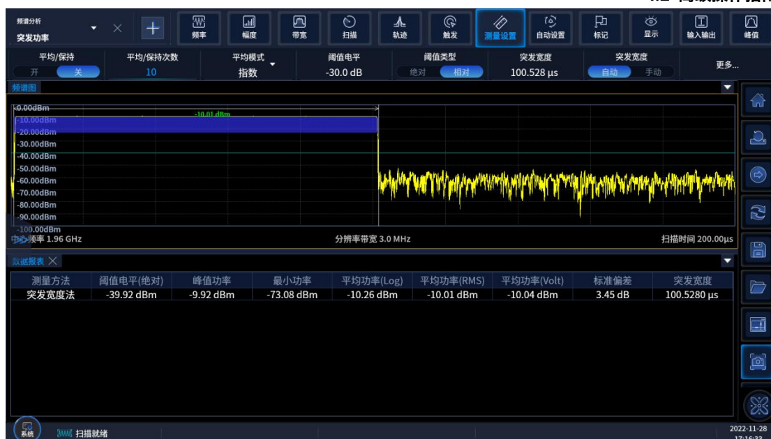
图 4.21 突发功率测量结果
