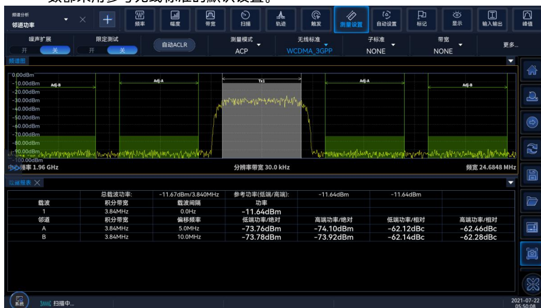
图 4.13 邻道功率测量结果
