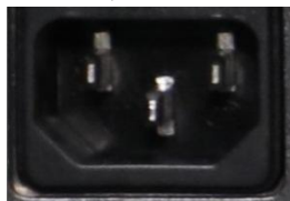
图 3.1 4071 后面板电源插座
