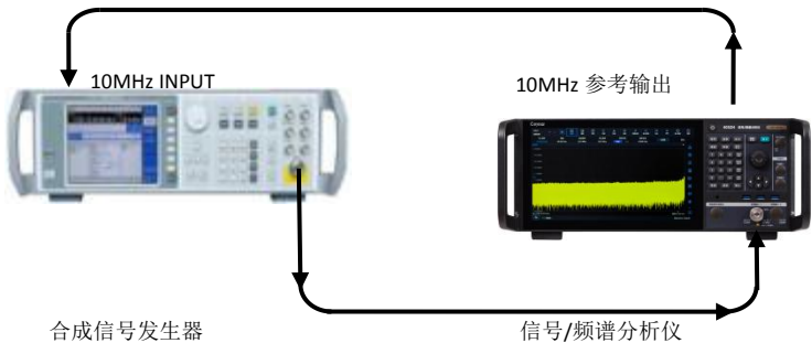
图 7.4 标记计数测试示意图
