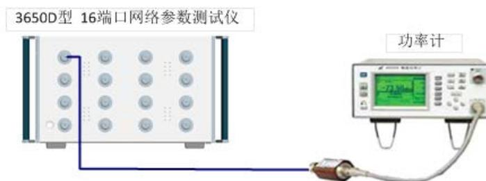
图 9.4 端口输出功率测试框图
