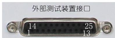
图 3.31 外部测试接口连接器
