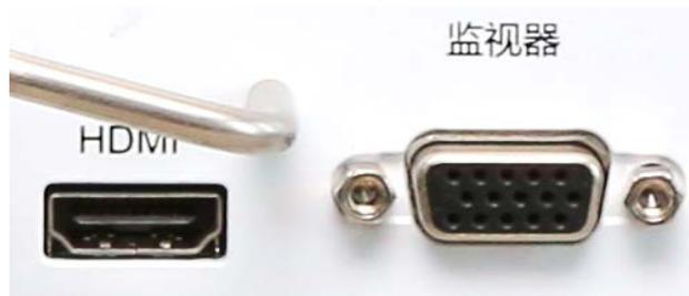
图 3.26 视频图形适配器输出连接器
