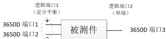
d) 单端-单端/平衡 (3 个逻辑端口和 4 个 3650D 物理端口)
