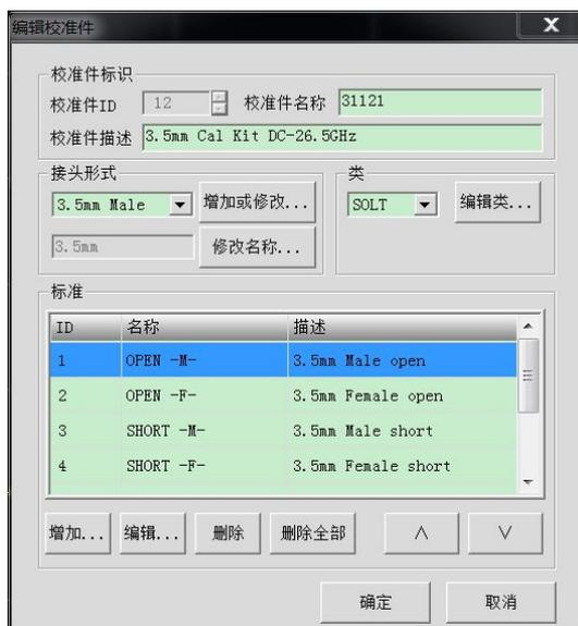
图6.19 编辑校准件对话框
