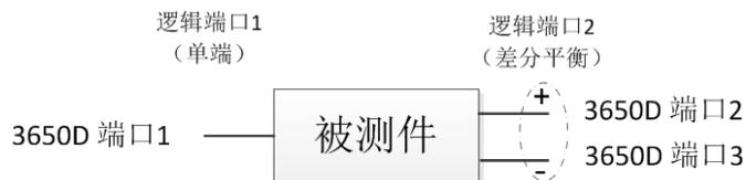
c) 平衡/单端 (2 个逻辑端口和 3 个 3650D 物理端口)
