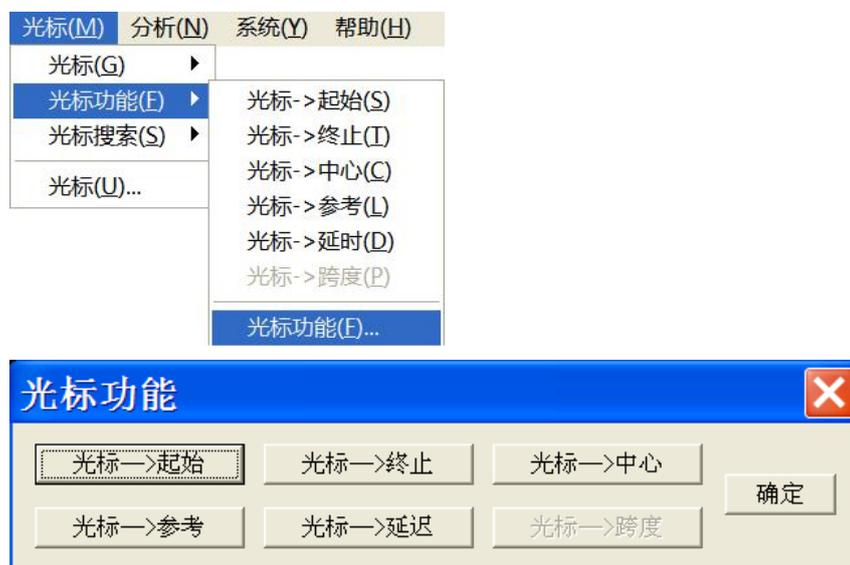
图 3.43 使用光标功能对话框设置测量
