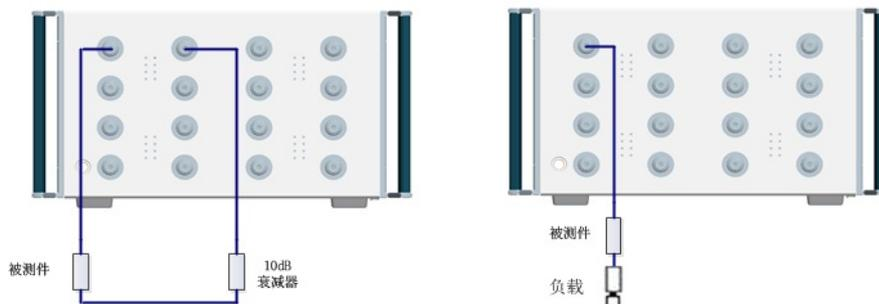
图 7.10 阻抗测量连接
