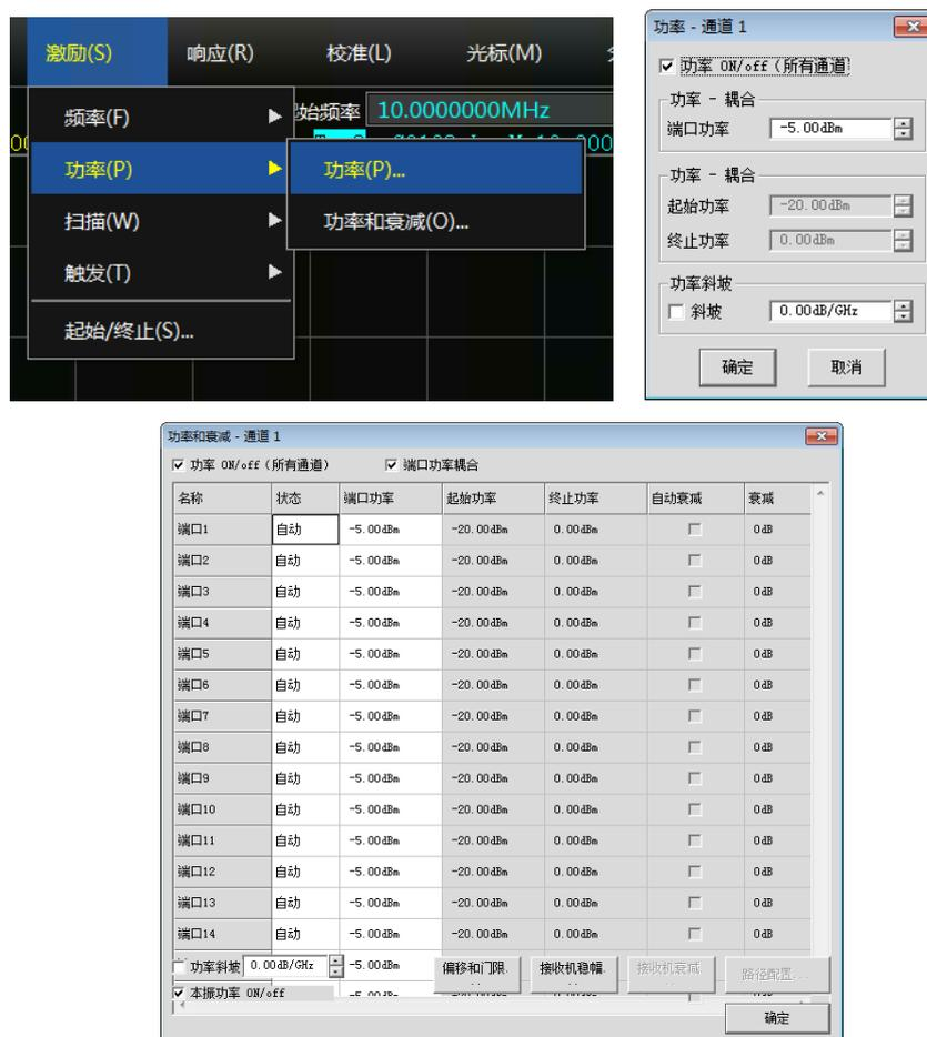
图 4.13 设置功率电平
