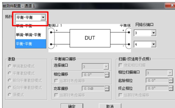
图 4.7 差分平衡 S 参数拓扑设置对话框
