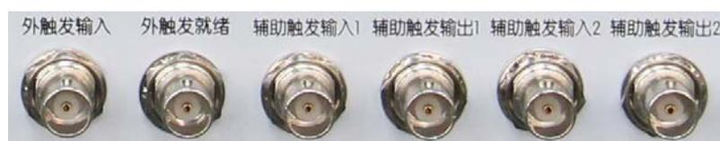
图 3.32 触发输入/输出接口连接器
