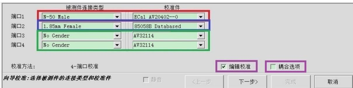
图6.4 向导校准：选择被测件的连接类型和校准件页面
