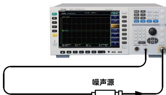
图 4.7 上、下变频器测试模式校准连接
