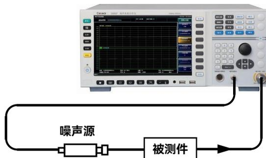
图 4.4 基本放大器测量模式测量连接图示
