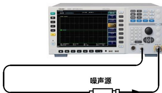
图 4.9 配备标准噪声源的校准连接图示
