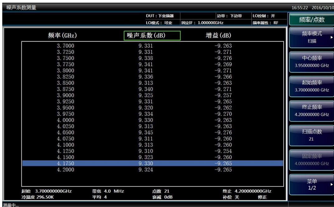
图 4.30 下变频器测量模式典型的测量结果显示
