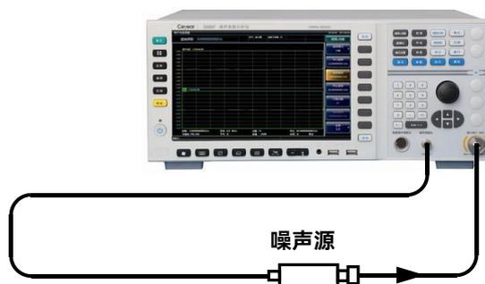
图 4.3 基本放大器测量模式校准连接图示
