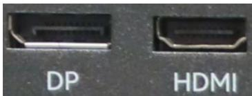
图 2.22 显示接口 DP、HDMI 输出连接器
