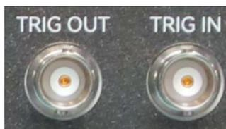
图 2.23 触发输入/输出接口连接器
