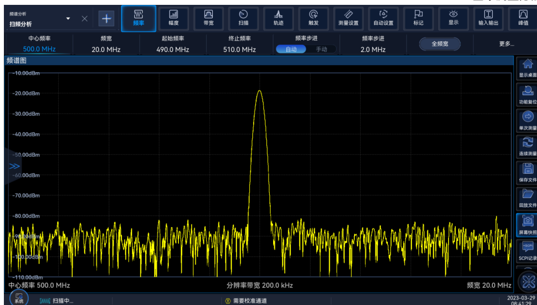
图 3.12 设置优化后的校准信号频谱
