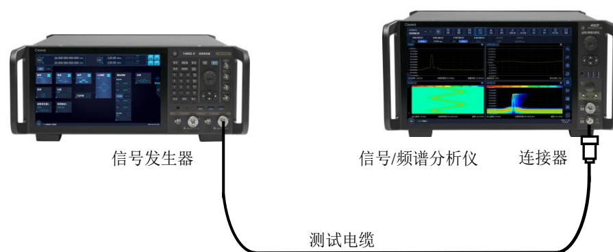
图 4.25 谐波失真测量连接设置
