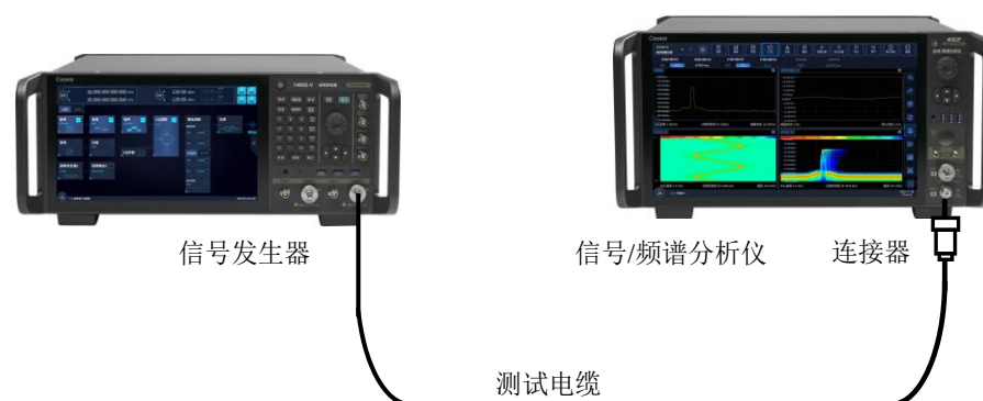
图 4.19 邻道功率测量连接设置
