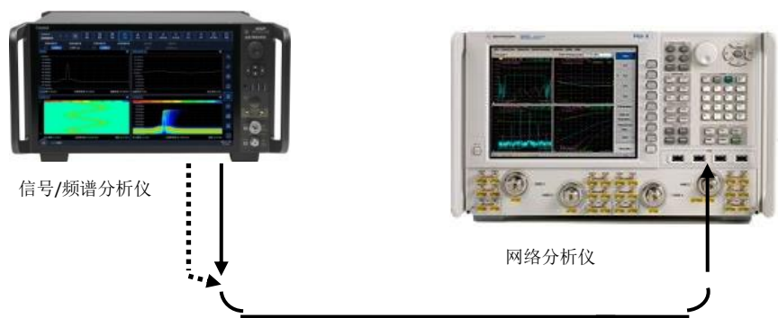
图 7.21 输入端口电压驻波比测试示意图
