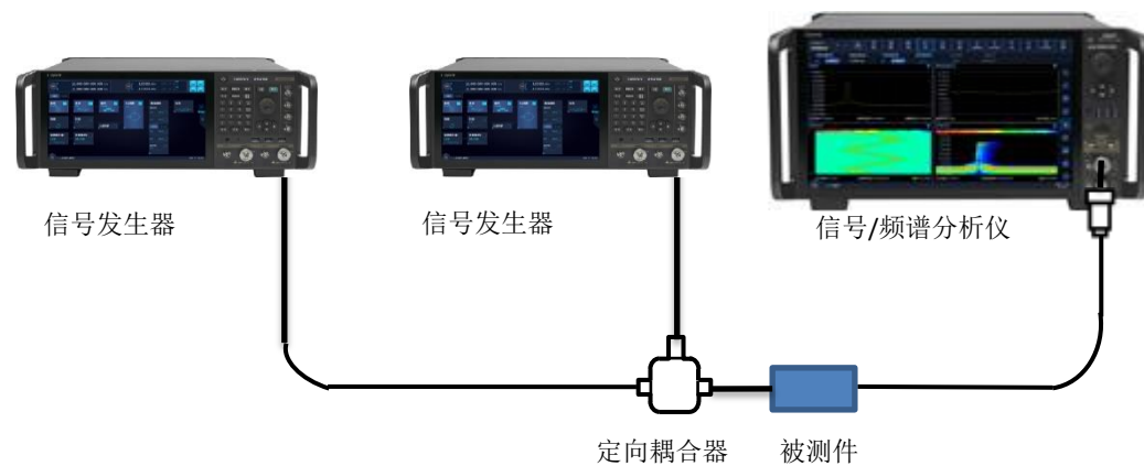
图 4.27 三阶交调测量连接设置
