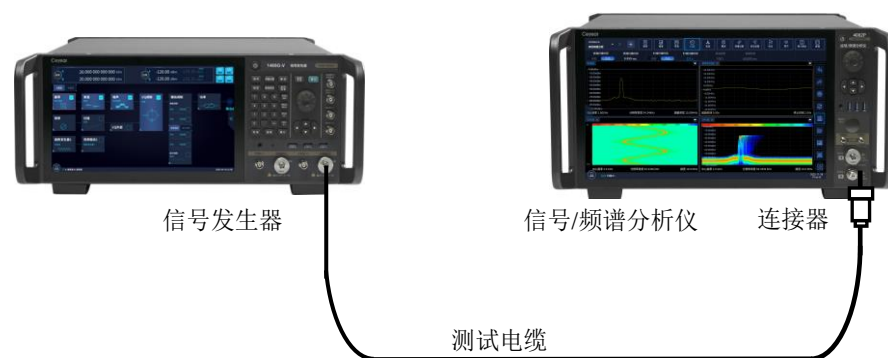
图 4.29 杂散发射测量连接设置
