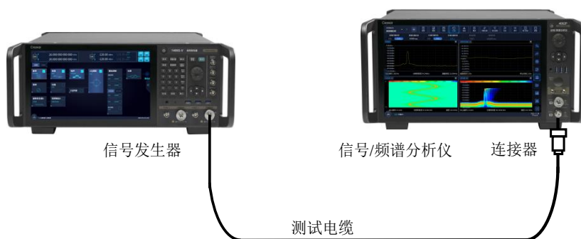
图 4.10 相位噪声测量连接设置
