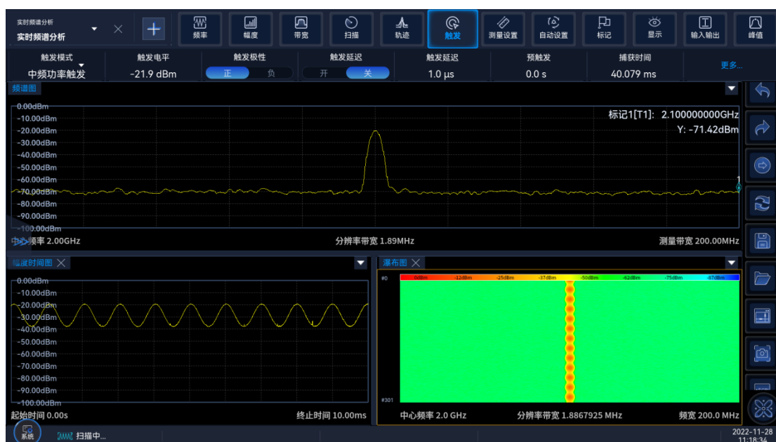
图 4.44 中频功率触发设置示意图
