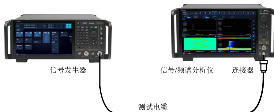
图 4.13 占用带宽测量连接设置
