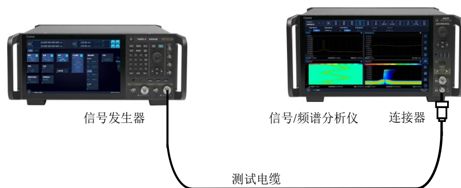
图 4.23 突发功率测量连接设置
