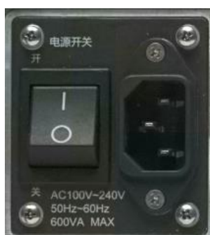
图 3.1 4082 后面板电源插座与电源开关
