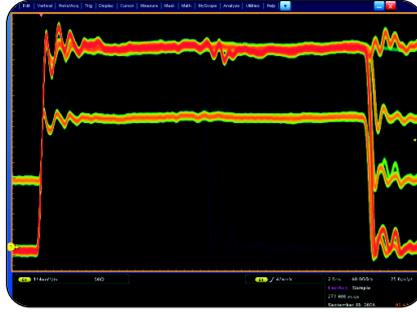
► FastAcq 采集模式最大限度地提高了捕获难以琢磨的毛刺和其它偶发事件的概率。
