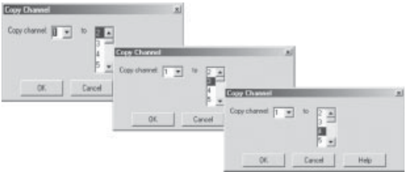
图 5. 将通道 1 复制到通道 2、3 和 4 上，以测量第二个基频，低端混频分量和高端混频分量。
