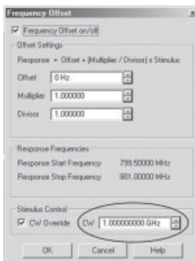
图 12.将连续波优先用于 IMD 测量
