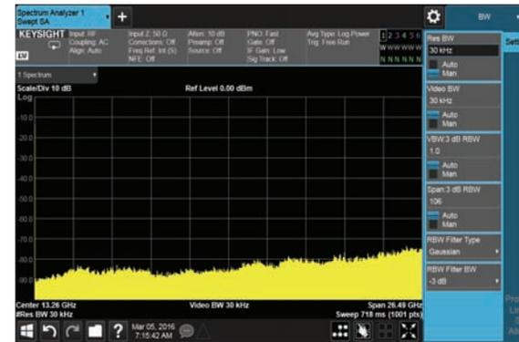
采用是德科技最新的数字滤波技术, 只需要 718 毫秒就可以利用 30 kHz 的 RBW 滤波器扫描完整个 26.5 GHz 的频率范围。
