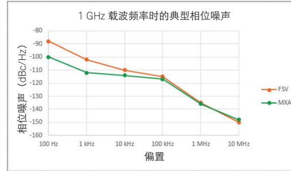
1 GHz 载波的典型相位噪声性能随频偏的变化。
