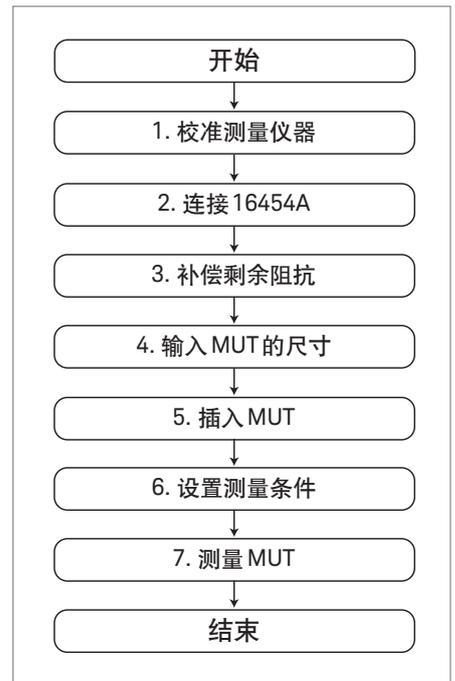
图 30. 16454A 的测量过程流程图
