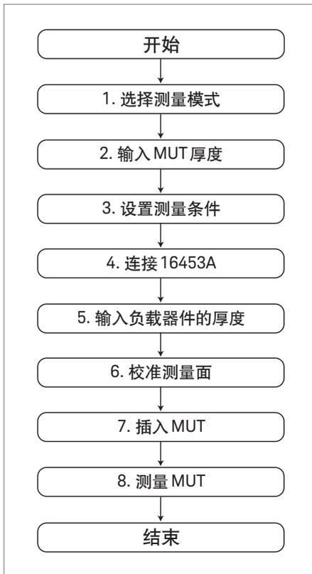
图 19. 16453A 的测量过程流程图
