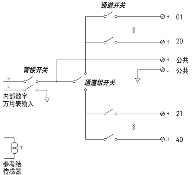
注: 热电偶必须彼此绝缘, 以免形成电流环路, 从而产生测量误差。
