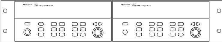
要在机架中并排安装两台仪器, 请订购 34191A 2U 双镶条套件和 34194A 互锁套件。
