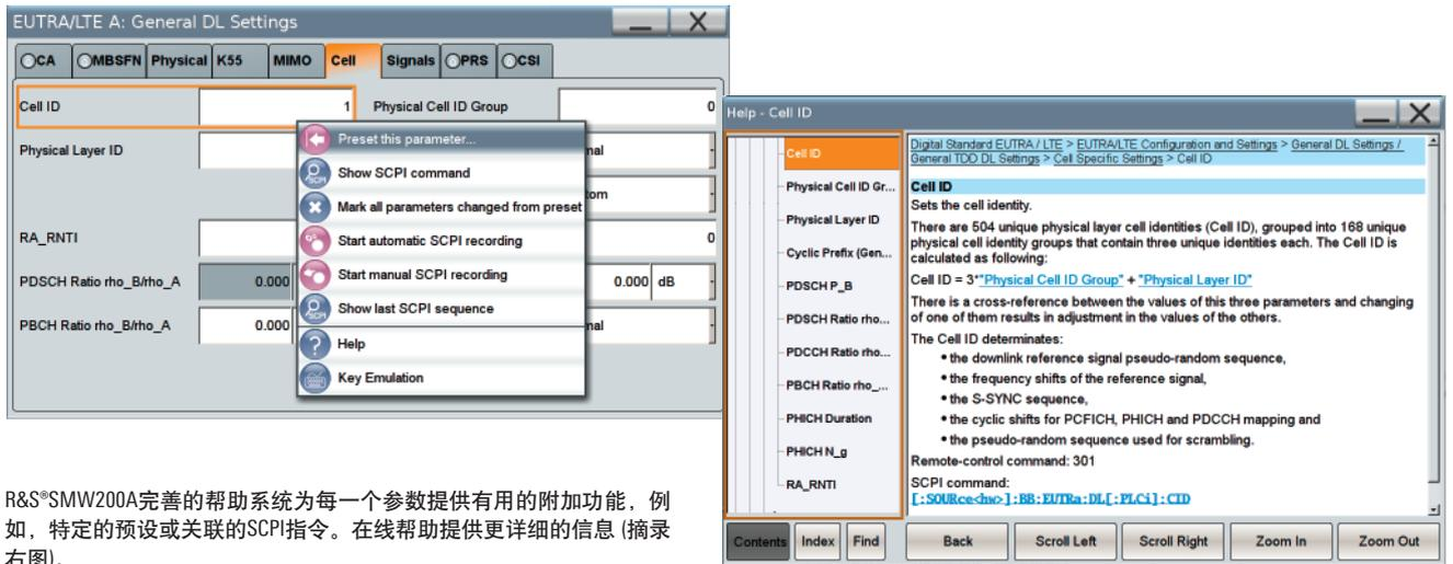
R&S®SMW200A完善的帮助系统为每一个参数提供有用的附加功能，例如，特定的预设或关联的SCPI指令。在线帮助提供更详细的信息（摘录右图）。
