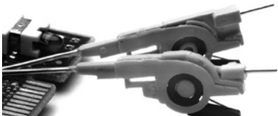
极小尺寸的夹具可用于 PQFP 和 SOIC SMT 封装探测
