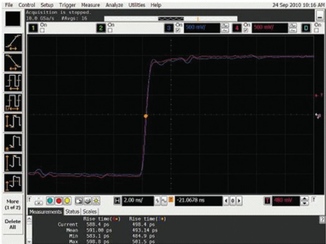
N2796A 的时域阶跃响应 (使用 Keysight MSO9404A)
