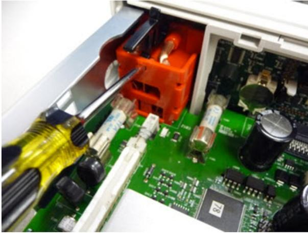
7. 推入所示的杠杆，然后压挤仪器的金属框以释放前面板塑料。
