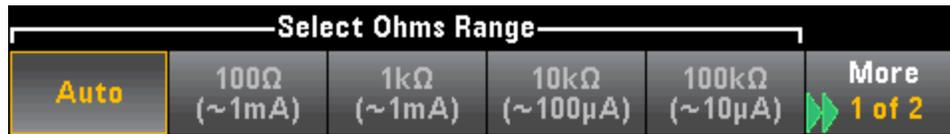
请注意,将显示每个量程提供的测试电流量。选择量程后,将显示电阻主菜单。
