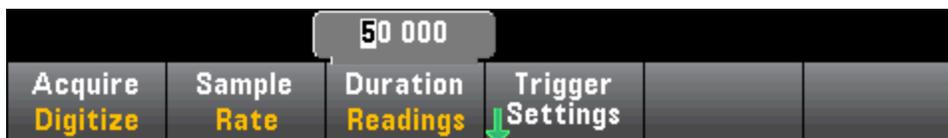
**步骤 5:** 按 **Trigger Settings** 查看或更改触发源。默认情况下，触发源设置为 **Auto**。您也可以在进行数字化时选择外部和电平触发。
