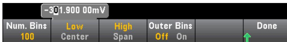
对于 **Binning Auto**，通过以下方式开始此算法：根据传入的读数，连续重新调整直方图跨度，在新值超出当前跨度时，对数据重新进行完全柱形处理。在采集大量读数后，超出此量程的新读数会使柱形按这两个因子进行压缩，以使新的柱形范围覆盖新的读数。所显示的柱形数是收到的读数个数的函数：0 到 100 个读数 = 10 个柱形，101 到 500 个读数 = 20 个柱形，501 到 1000 个读数 = 40 个柱形，1001 到 5000 个读数 = 100 个柱形，5001 到 10000 个读数 = 200 个柱形 >10000 个读数 = 400 个柱形。如果 NPLC 设置小于 1 PLC，或孔径时间(仅限 34465A/70A)小于 20 mS，则最大柱形数为 100。
