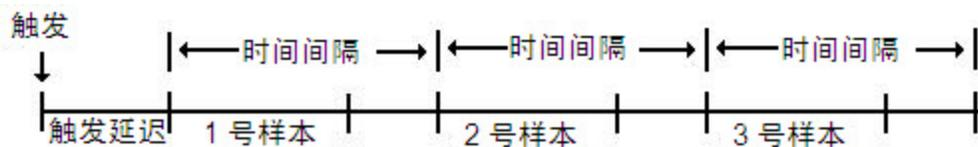
采样定时是决定性的，因为每次采样的开始时间是由采样间隔所决定的，采样间隔使用 `SAMPlE:TiMer` 命令进行设置(`TRIGger:DELaY` 仅影响第一次采样的开始时间)。积分和自动调整量程影响每次采样的采样时间，但是只要采样间隔比采样时间长就不会影响采样间隔。
