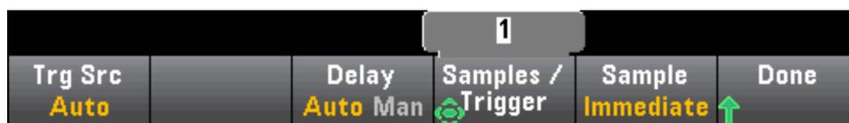
上述菜单的主要目的是让您配置测量触发，您还可以使用 **VMC Out** 软键设置仪器后面板上 **VM Comp**(电压表完成)输出的边沿斜率。每当电压表完成一次测量，此连接器都会发出一个信号，以让您向测量系统中的其他设备发送信号。
