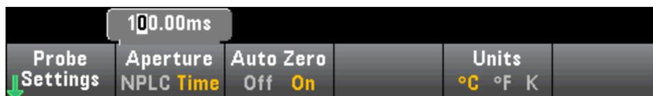
**Auto Zero:** 自动归零提供最准确的测量值，但是需要额外的时间来执行归零测量。自动归零启用 (On) 后，DMM 将在每次测量后对偏移进行内部测量。然后从前一次的读数中减去该测量值。这样就避免 DMM 输入电路上的偏移电压影响测量准确度。在禁用 (Off) 自动归零的情况下，DMM 对偏移进行一次测量，并从所有以后测量的参数中减去该偏移值。每次您更改函数、量程或积分时间时，DMM 进行一次新的偏移测量。(4 线测量没有自动归零设置。)
