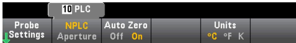
**Auto Zero:** 自动归零提供最准确的测量值，但是需要额外的时间来执行归零测量。自动归零启用 (On) 后，DMM 将在每次测量后对偏移进行内部测量。然后从前一次的读数中减去该测量值。这样就避免 DMM 输入电路上的偏移电压影响测量准确度。在禁用 (Off) 自动归零的情况下，DMM 对偏移进行一次测量，并从所有以后测量的参数中减去该偏移值。每次您更改函数、量程或积分时间时，DMM 进行一次新的偏移测量。(4 线测量没有自动归零设置。)
