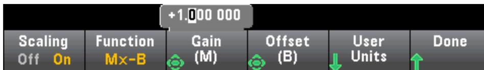
对于 Mx-B 标定，结果 = 测量结果 \* **Gain (M)** 值 - **Offset (B)** 值。
