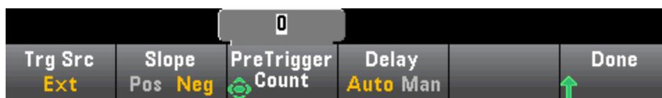
**Ext** - 当适当的斜率沿达到后面板 **Ext Trig** 连接器时，此仪器会触发。您可以指定在 **Trg Src** 设置为 **Ext** 时所显示的软键菜单上的斜率。要选择外部触发，请按 **Ext**，然后选择 **Pos** 或 **Neg** 斜率：
