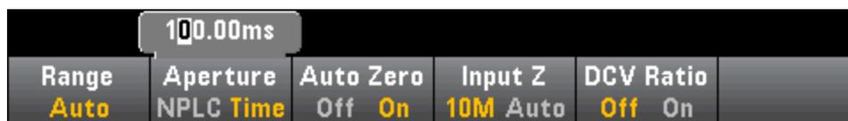
**步骤 4:** 按 **Range** 为测量选择一个量程。您也可以使用前面板上的 **[+]**、**[-]** 和 **[Range]** 键来选择量程。**Auto**(自动调整量程)根据输入为测量自动选择量程。与手动量程相比, 自动调整量程比较方便, 但会导致测量较慢。自动调整量程可向上调整到当前量程的 120%, 向下调整到当前量程的 10% 以下。
