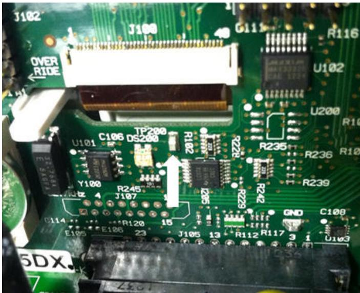
10. 还要验证电阻器 R121 的电压是  $3.3 \text{ V} \pm 5\%$ , 与仪器机架对应。如果此电压不正确,更换前面板。
