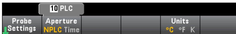
要精确地设置积分时间(不使用 PLC), 请按 **Aperture Time** 并使用左/右和上/下箭头键指定积分时间, 以秒为单位。对于 **Aperture Time**, 您可以指定从 200  $\mu\text{s}$ (20  $\mu\text{s}$ , 带有 DIG 选项)至 1 s 的积分时间 (2  $\mu\text{s}$  解析度):
