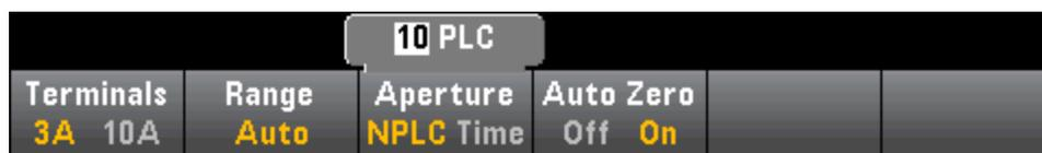
**步骤 3:** 对于 34465A/70A，默认情况下 **Aperture NPLC** 软键是选中状态。使用上/下箭头键在电源线循环次数 (PLC) 中指定积分时间以用于测量。1、10 和 100 PLC 提供正常模式(线路频率噪声)抑制。选择 100 PLC 可提供最佳噪声抑制和解析度，但测量速度最慢：
