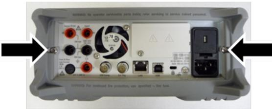
5. 去除仪器底部的螺丝，将其放在安全的位置，以备重新组装使用。滑下仪器盖。
