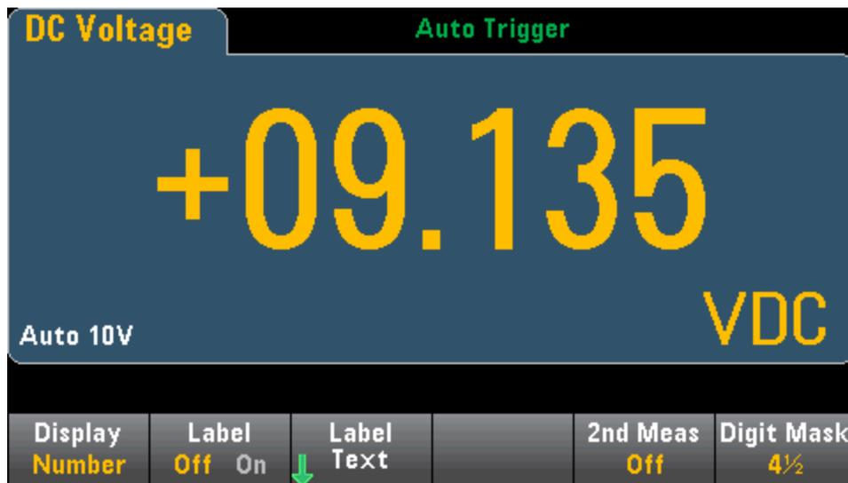
**Auto** 软键指定所显示的位数基于其他特定函数设置，如测量间隙、NPLC 设置。测量结果会被取整，不会被截断。
