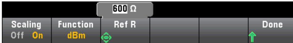
dBm 函数是一个对数表达式，比较传递到参考电阻的电量，相对于 1 mW:
