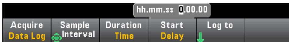
**NOTE** 在记录数据时无法配置触发源。您只能使用自动触发(默认选项)，或者在准备启动数据记录时，您可以使用单次触发(通过按 **[Single]**)。当您只需要一个自动触发或单次触发事件来启用数据记录时，效果是相同的。
