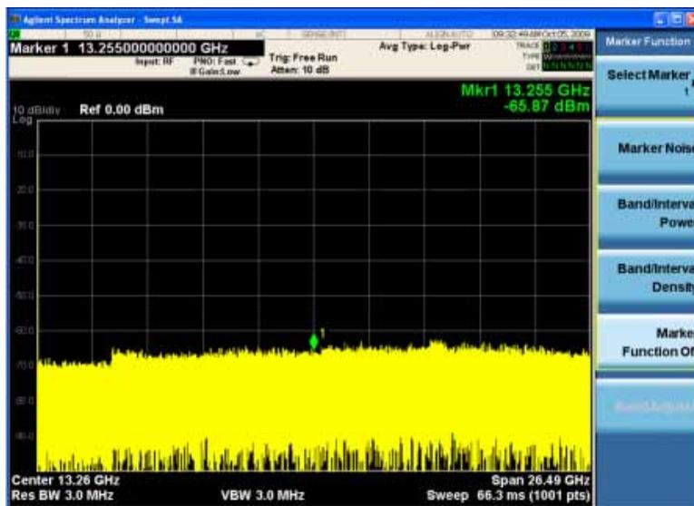
一些键通过菜单左侧的黄色长条区被组合在一起。当您按黄色长条区的键，如 **Marker Noise**，这个键被突显表明已被选中。黄色长条区内的按键的功能互相关联，一次仅能选择一个。如，**marker** 在当前仅能使用一个功能。所以如果您选择了其它的功能将关闭前面选择的功能。如果当前的菜单有两页，第二页的按键也可能含有黄色长条。
