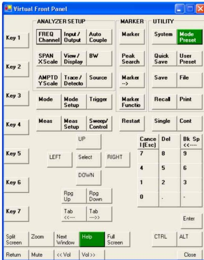
点击虚拟前面板的按钮效仿相应的前面板按键操作。在此面板左侧的按键 Key 1 到 Key 7，效仿各自的软按键操作。Rpg Up 和 Rpg Down 按键效仿旋钮操作。
