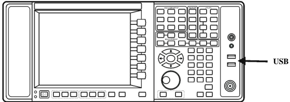
后面板方形的 USB 端口（如下图）是 USB “B” 系列，用于控制仪器。N9060A 用户指南为您提供仪器编程的信息。仪器的 USB 软件驱动支持测试测量工业标准驱动类型 USBTMC-USB488。
