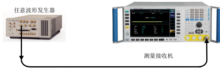
图 8.3 FM 调制测量示意图
