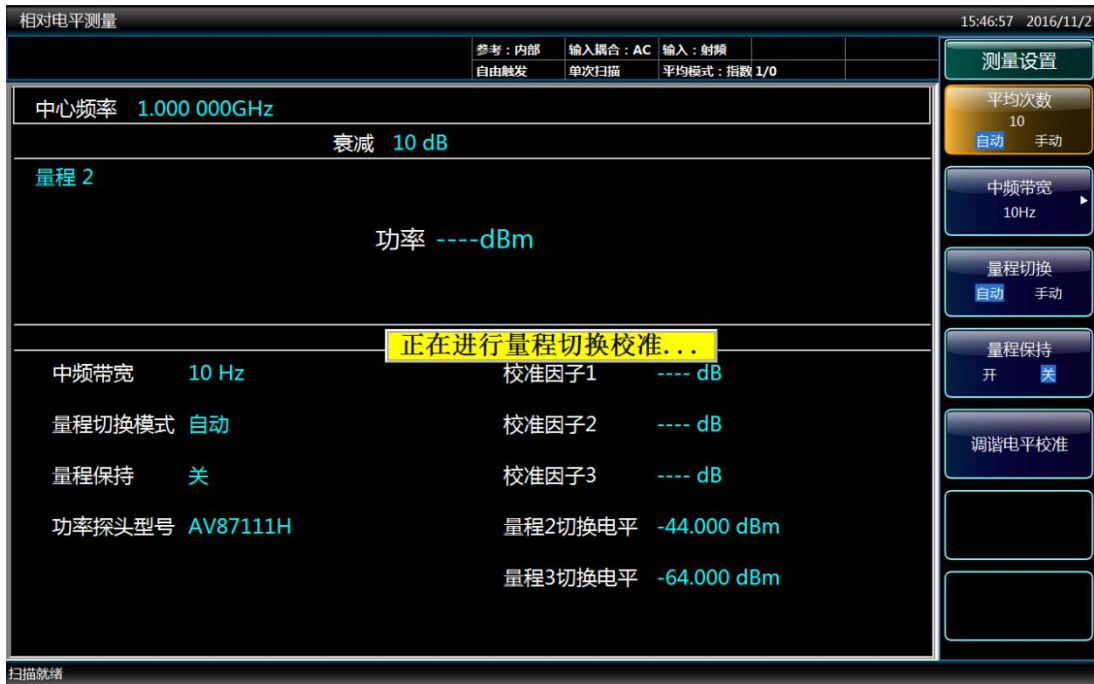
图 4.9 量程 2 的校准过程
