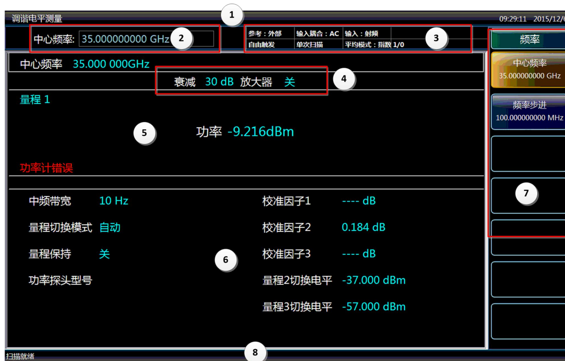
图3.18 调谐电平测量显示界面
