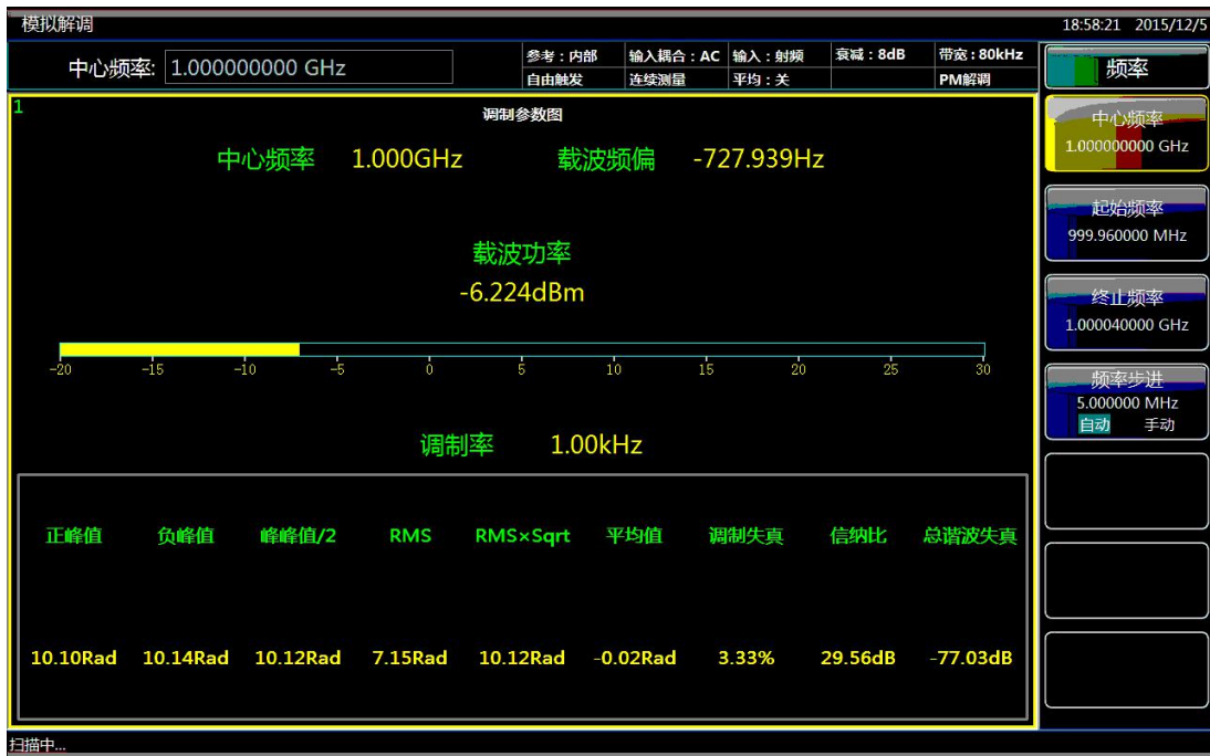
图 4.22 \Phi M 信号测量结果
