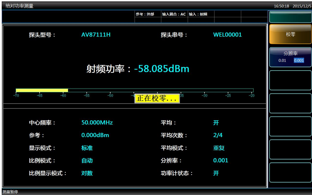
图 4.4 功率计校零操作
