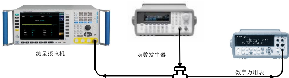
图 8.8 音频分析测试示意图
