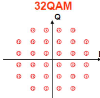
附图6 32QAM星座图
