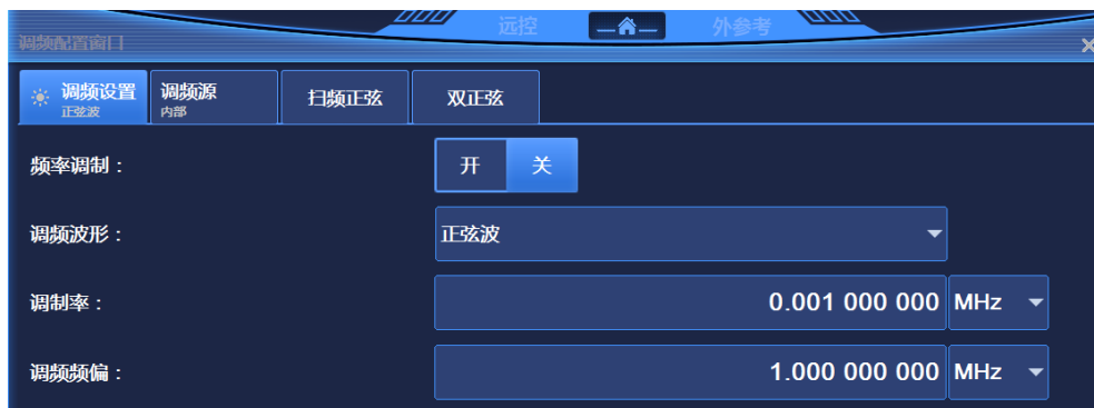
图 3.33 频率调制配置窗口
