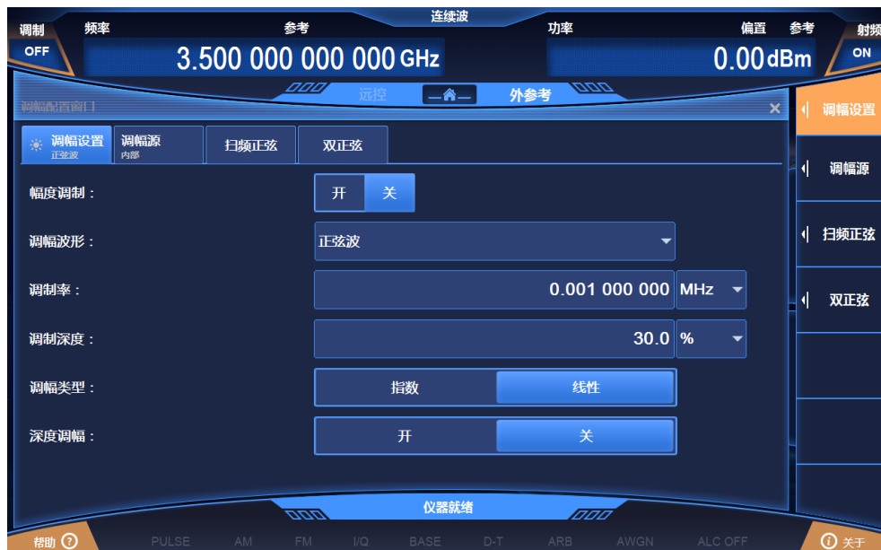
图 3.22 设置调幅信号
