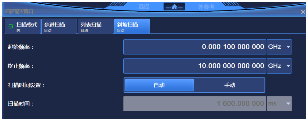
图 4.7 斜坡扫描配置窗口
