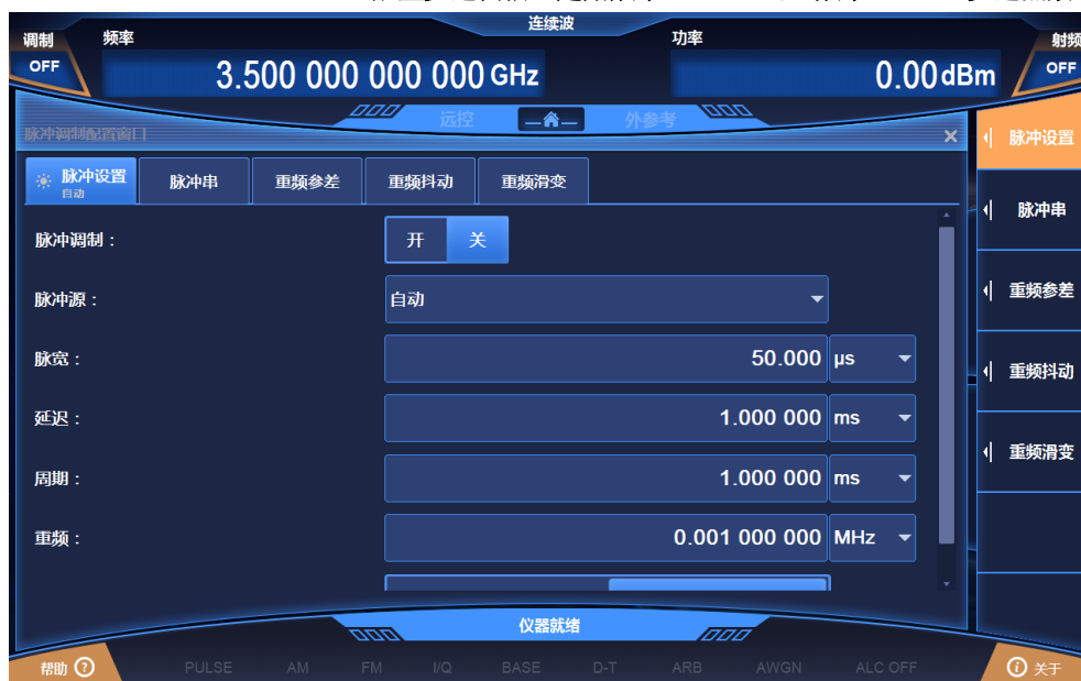
图 3.4 设置脉冲调制信号
