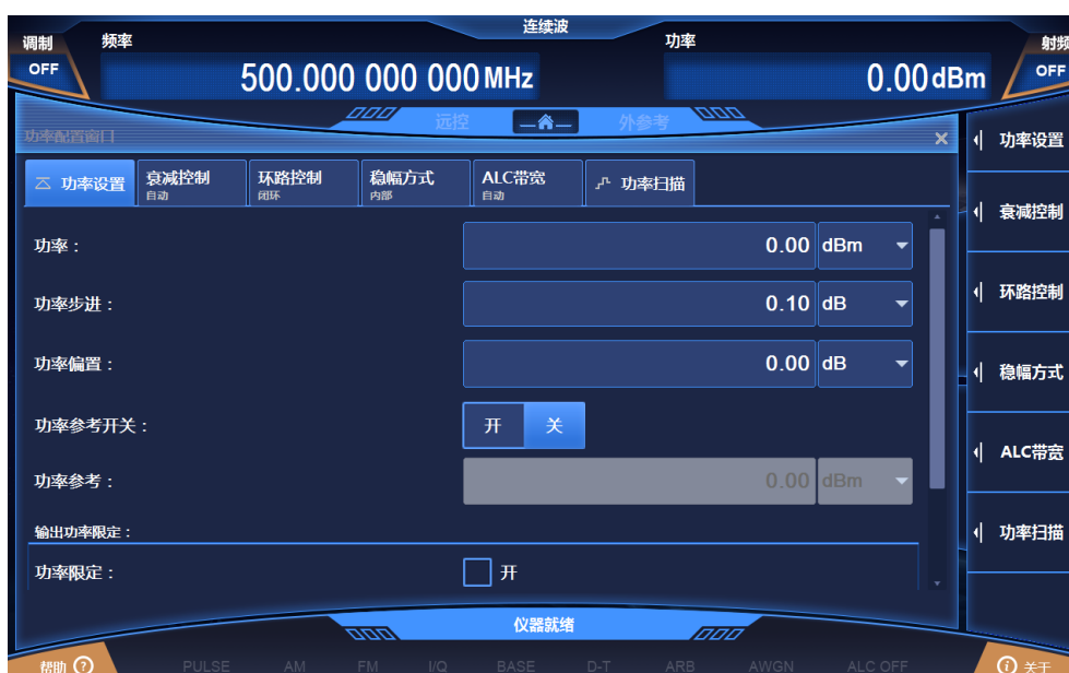
图 3.2 设置功率电平 0dBm，功率步进 0.1dB
