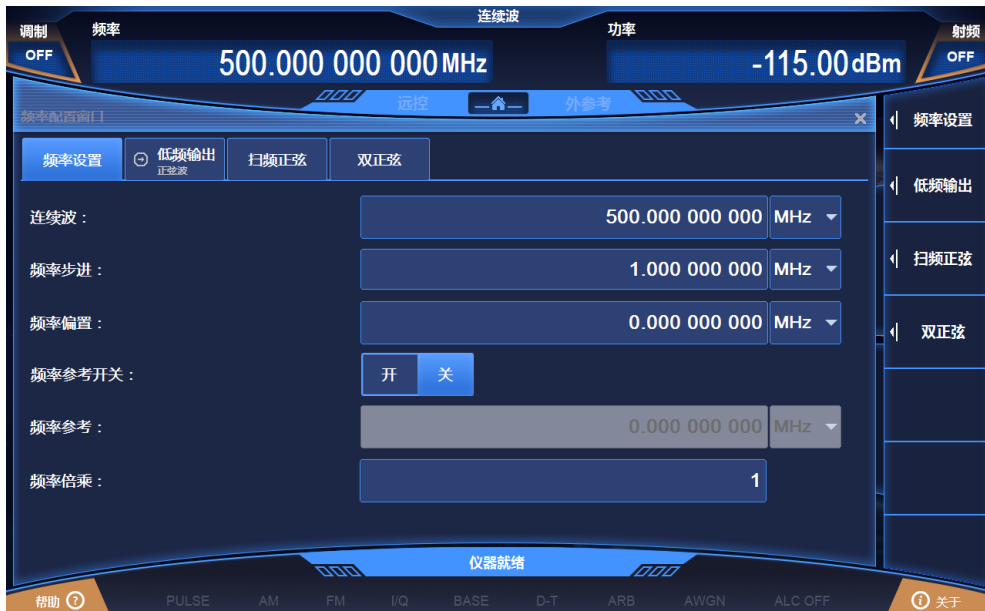
图 3.1 设置连续波 500MHz，频率步进 1MHz
