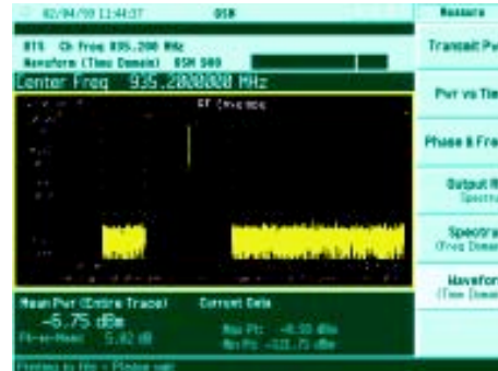
在 Agilent E4406A VSA 系列发射机测试器上，GSM 配置的时域测量（见图左部）
